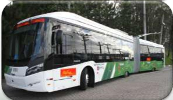
Os trólebus modernos são equipados com baterias que permitem o deslocamento, sem rede aérea, por até 7km com carga máxima. A distância entre uma subestação e outra é em média de 1km a 3km. Esta nova tecnologia acaba com as interrupções no sistema trólebus, decorrentes de acidentes com a rede ou com a subestação.
